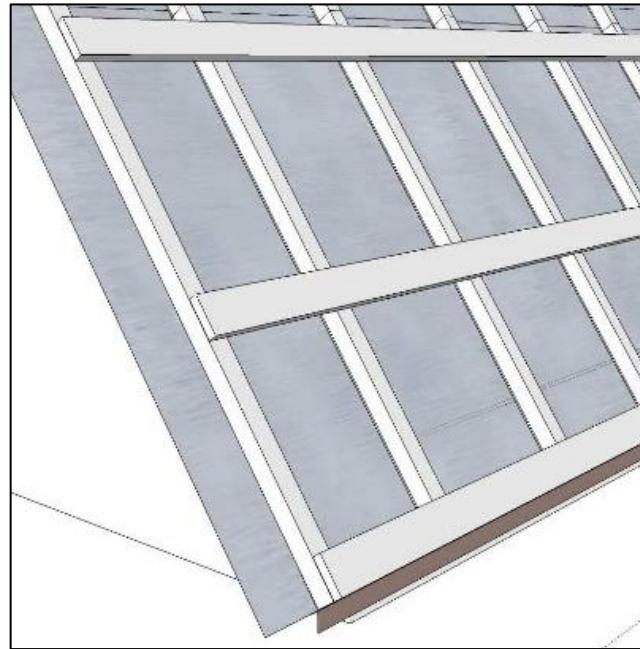
Прикрепите дополнительный брускок контробрешетки к нижней части технологической обрешетки, выровняв его по размеченной линии фронтонов, используя по возможности всю длину бруска.
