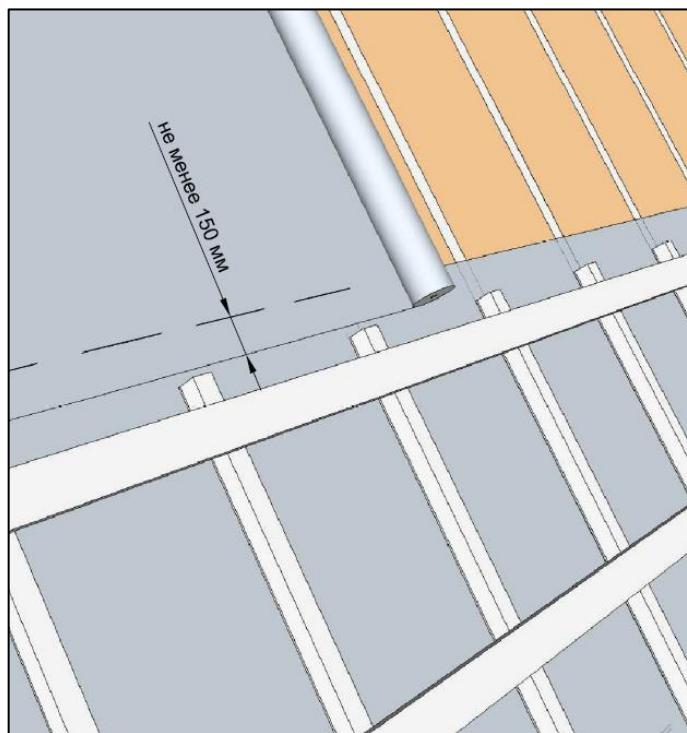
**ВНИМАНИЕ!** Убедитесь в ровности стропил в нулевой плоскости перед началом работ. Незначительные отклонения от плоскости на этапе монтажа гидроизоляции возможны, они должны быть устранены при дальнейшем монтаже контробрешетки и обрешетки.
