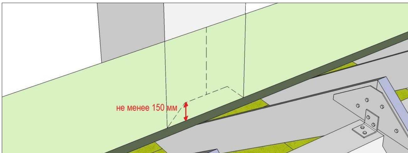
Расправьте полотно и закрепите гидроизоляцию скобами к стропилам при помощи степлера.
