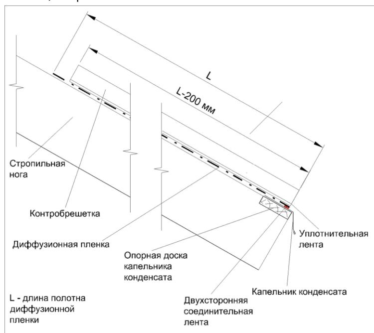
Нарежьте отрезки уплотнительной ленты с длиной равной ширине полотна на карнизе за вычетом 200 мм.
