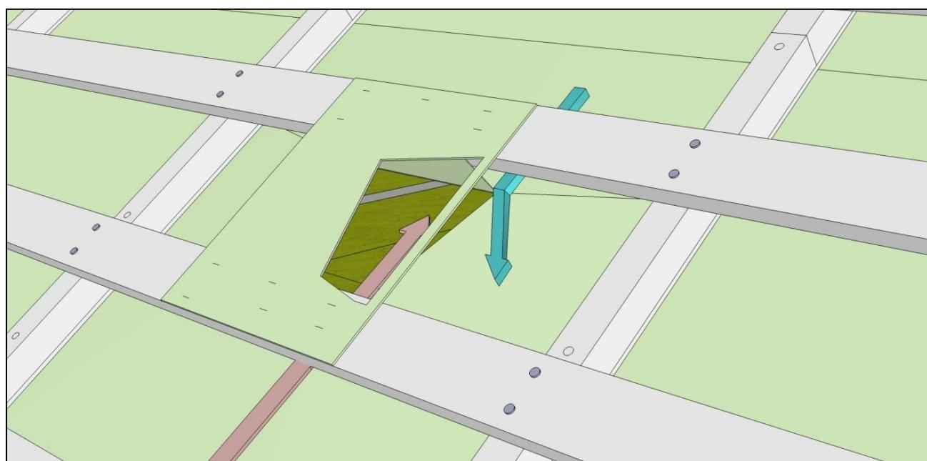
Фрагмент гидроизоляции (для наглядности показан с вырезом), смонтированный над «окном-трапецией» поверх обрешетки не помешает монтажу тех типов кровельного покрытия, при монтаже которых ни один элемент не опускается ниже плоскости
