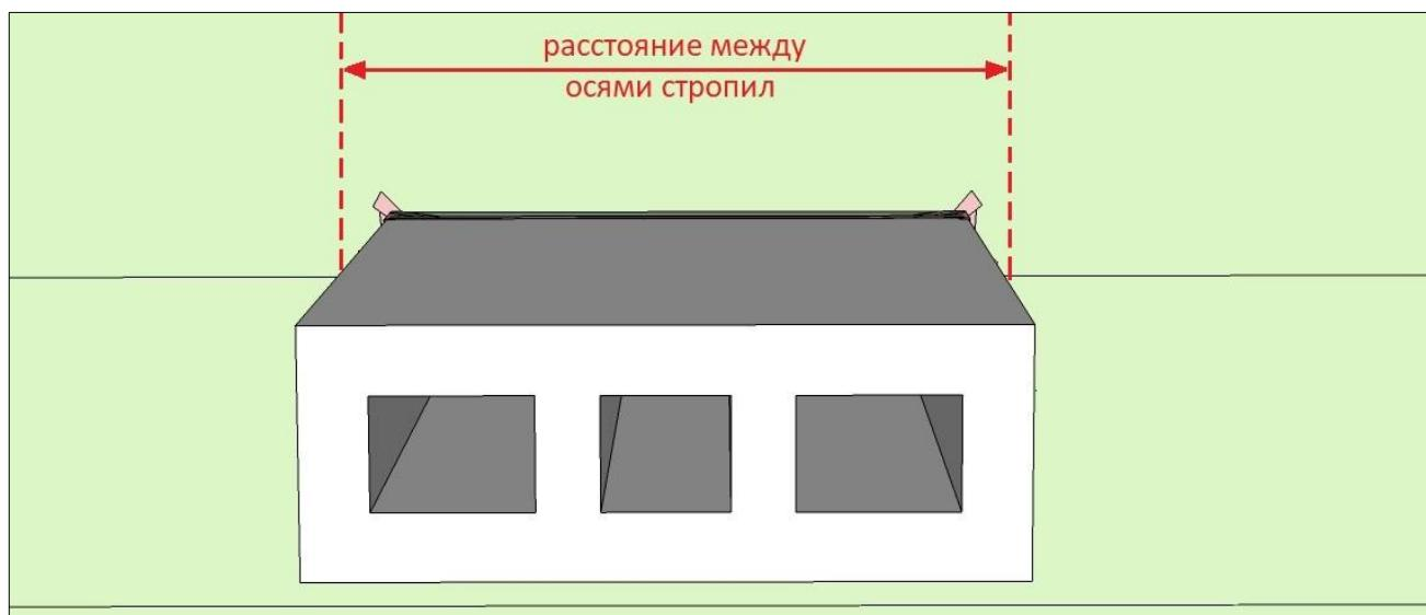
Расположите полотно гидроизоляции за трубой таким образом, чтобы получился уклон в одну сторону. Края полотна слева и справа должны выходить за грани стропил не менее, чем на 50 мм. Закрепите полотно по верхнему краю не далее 20 мм от его кромки к стропилам при помощи степлера.
