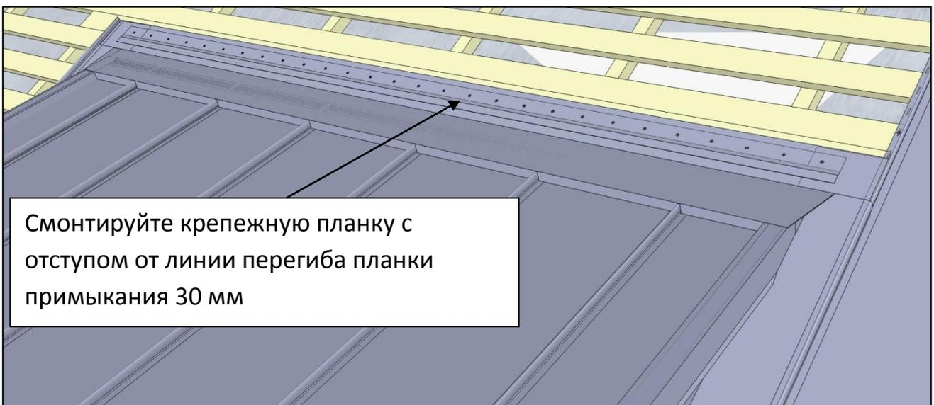
Смонтируйте крепежную планку с отступом от линии перегиба планки примыкания 30 мм
