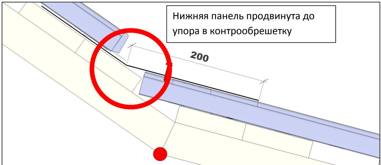
Ниже показано «полное моделирование» узла примыкания для разных углов наклона скатов. При наклоне верхнего ската 60 градусов нижние панели выдвигать вперед за обрешетку не нужно.
