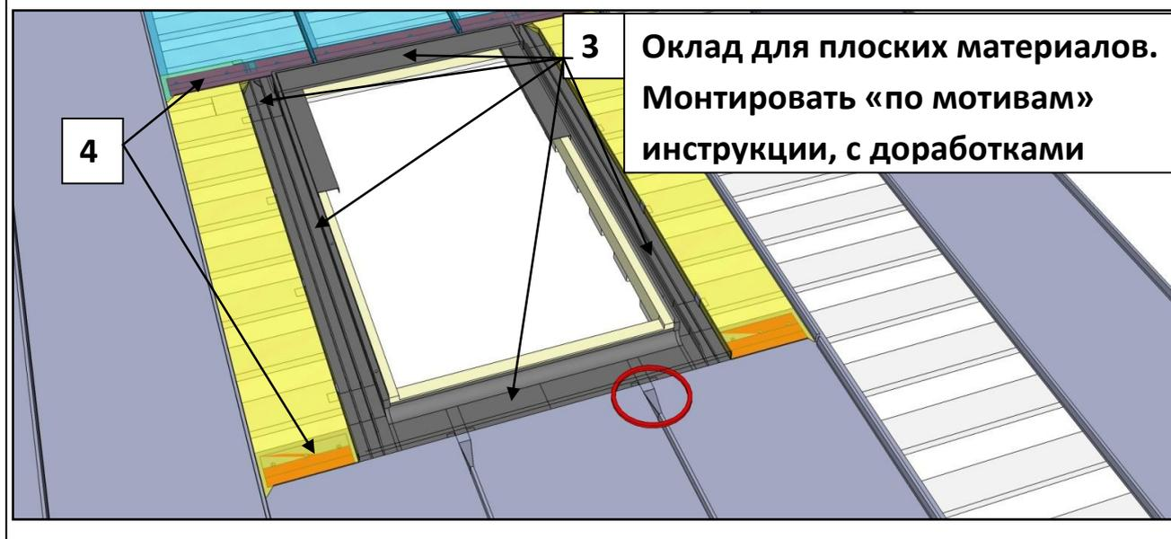
**Узел 620. Установка мансардного окна с окладом кровли-ЗАЩЕЛКИ.**
